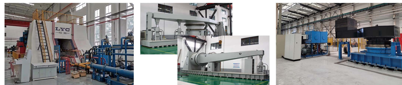
盾构机主轴轴承试验台 最大工件规格：Φ4800mm
