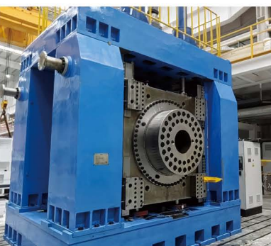
2022年 16MW-28MW齿轮箱试验台 刚性轴/低速轴连接器
